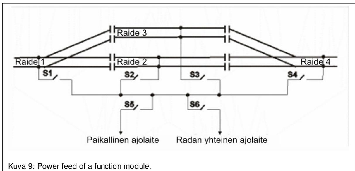
Kuva 9: Power feed of a function module.
